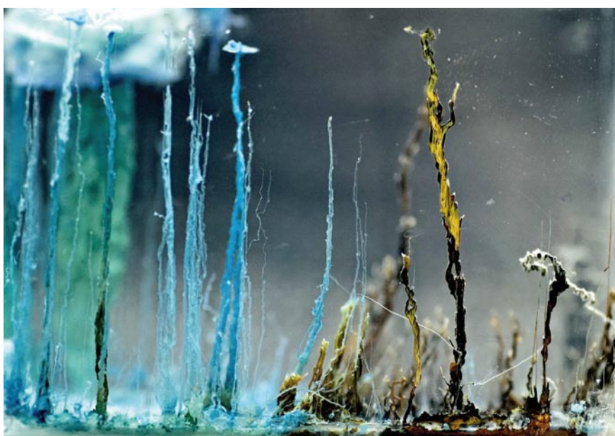
Figura 1. Jardines osmóticos obtenidos por la adición de cristales de sulfato de cobre y de sulfato ferroso a una solución de silicato de sodio
